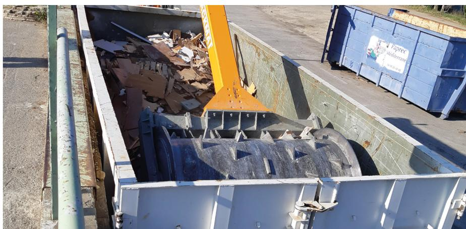
Compactage d'une benne avec le "PackMat"
